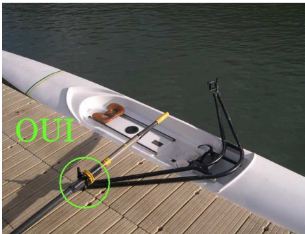
pelle bâbord (rouge) installée en premier
