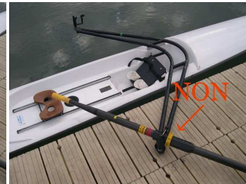
collier du mauvais côté
